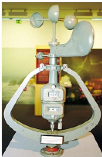
ITSAS ANEMOMETROA. Haizearen abiadura neurtzeko itsasontzietan erabiltzen zen tresna.
