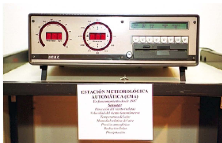
BEHAKETA METEOROLOGIKORAKO ESTAZIO AUTOMATIKOA. Haizearen norabidea eta abiadura, tenperatura, hezetasuna eta presio atmosferikoa neurtzen ditu.
