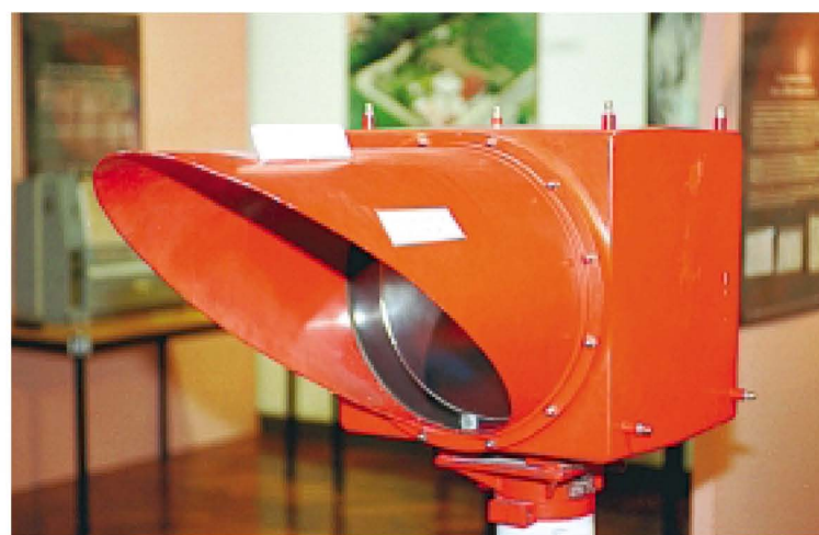
TRANSMISOMETROA. Ikuspen horizontala neurtzeko aireportutan erabiltzen da.
